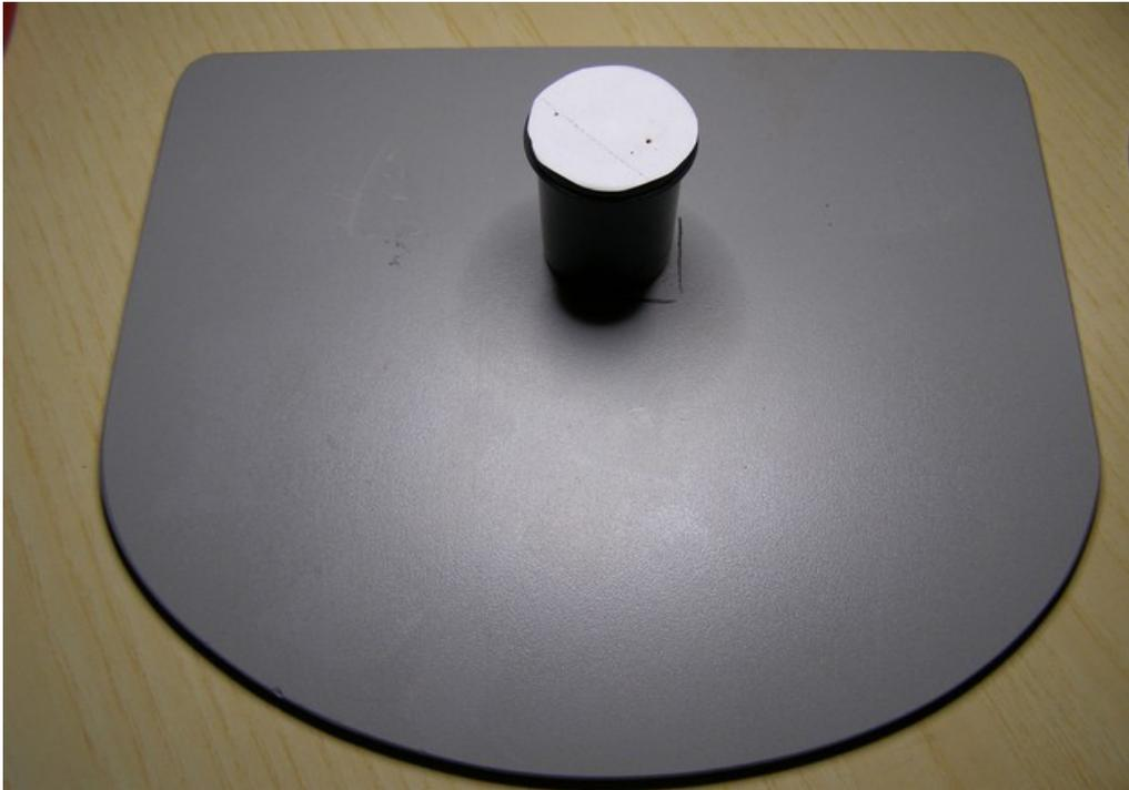
un contenitore per Diapositive riempito fino all'orlo di Plastozone, che servirà da supporto per l'alloggiamento dello spillo.
